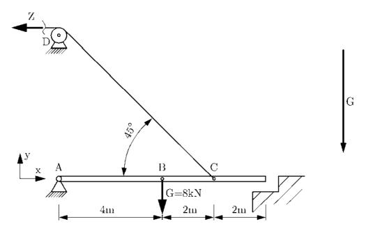
$[Z=7.5kN; A_x=5.3kN; A_y=2.7kN; D=5.8kN]$
